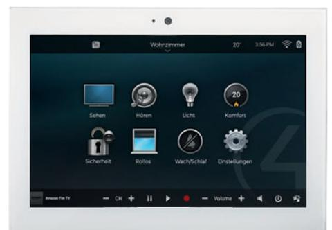
Die Touchscreens von Control4 erlauben neben der Intercom-Funktion auch die Anzeige installierter IP-Cameras sowie die Steuerung und Visualisierung der Haus- und Multimediaetechnik.
